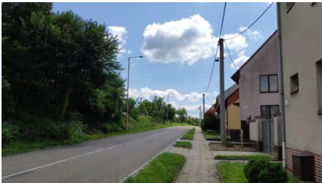
Obr. 126: Charakter VO v ulici Na Dědině – silnice III/05014 – světelné zdroje na vysokých stožárech s výložníkem.
