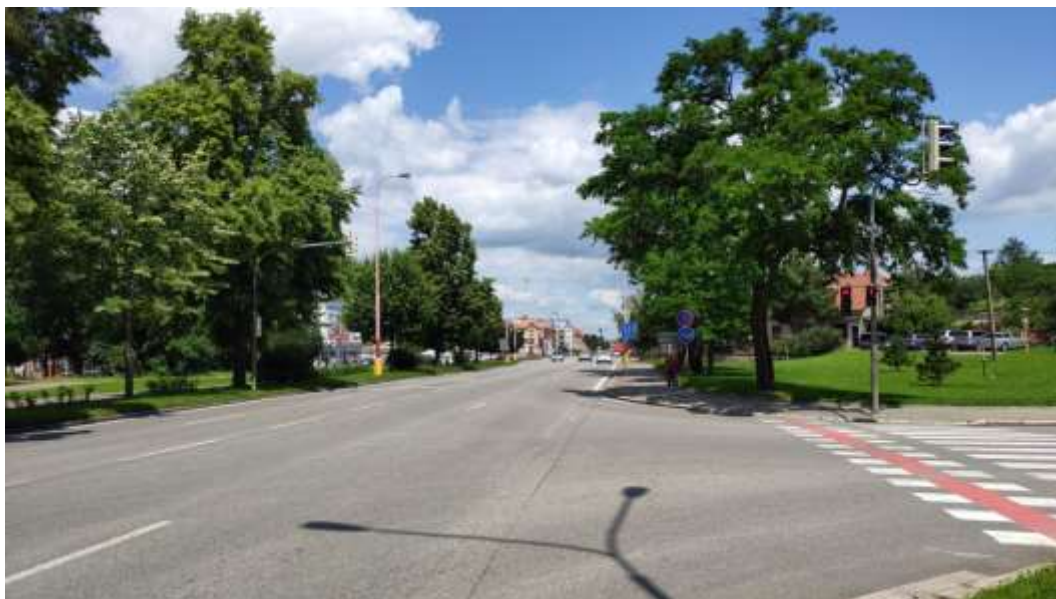
Obr. 118: Charakter VO na třídě Maršála Malinovského – silnice I/55 – světelné zdroje na vysokých stožárech s nástavcem, s patičí, svítidlo bez důrazu na design.
