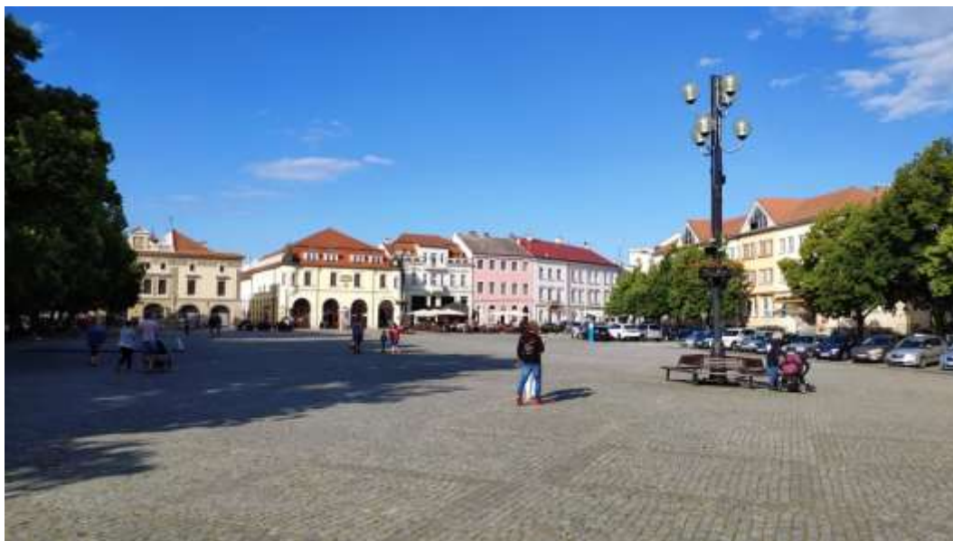
Obr. 68: Charakter VO v ploše Masarykova náměstí – sestava kulových svítidel na standardním odstupňovaném válcovém stožáru s patičí.
