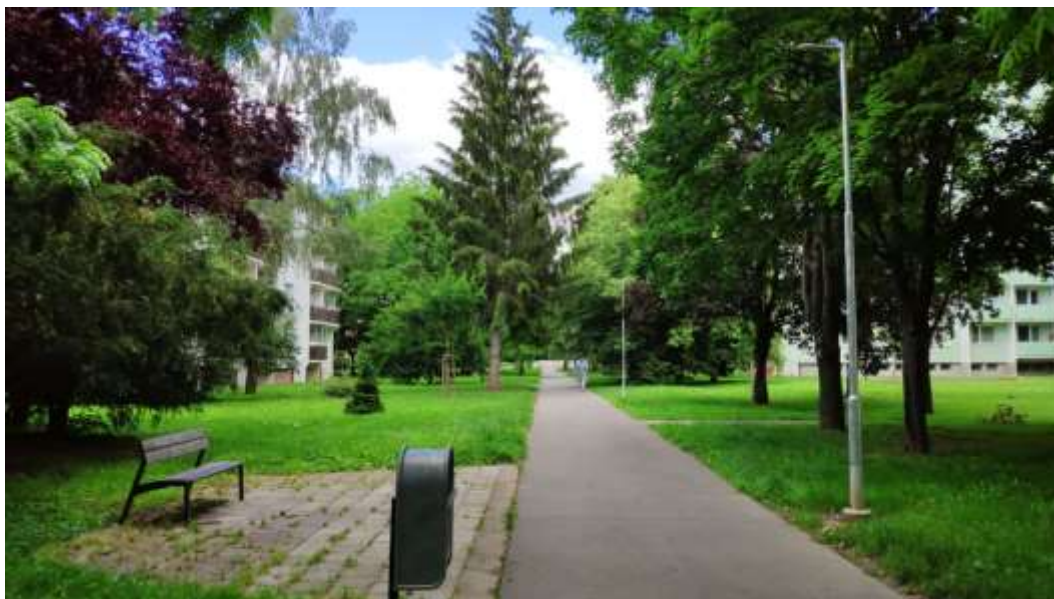
Obr. 96: Charakter VO na sídlišti Mojmír II - Štěpnice v ulici Jana Žižky – LED svítidla na odstupňovaných stožárech, bez patice.
