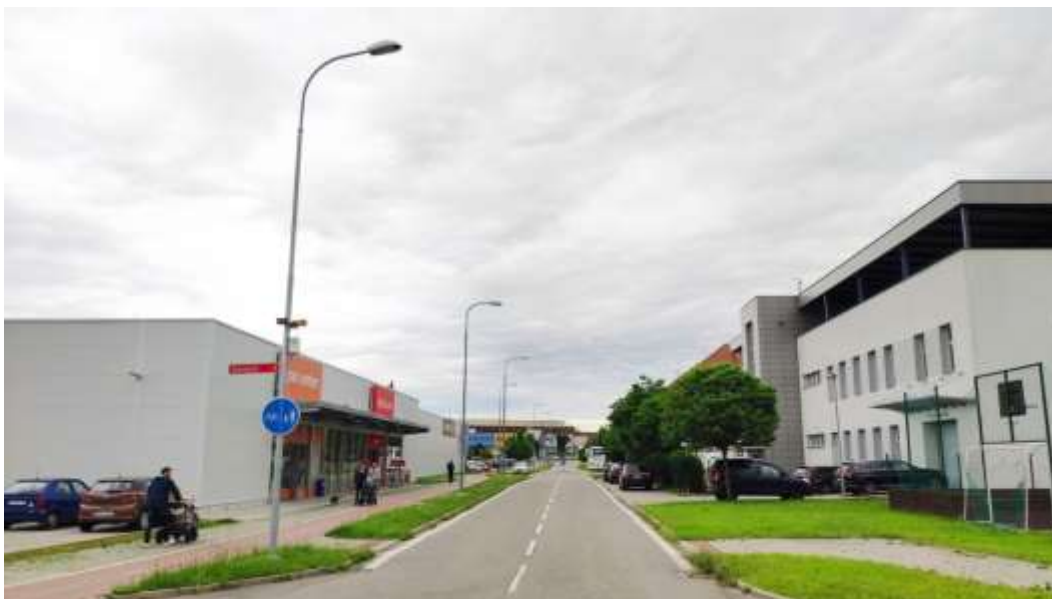
Obr. 104: Charakter VO v okolí obchodního centra Kaufland – ulice Města Mayen - světelné zdroje na vysokých stožárech s nástavcem. V ulicích mimo základní komunikační systém města by bylo vhodné zvážit snížení výšky svítidel, pokud to prostorové podmínky v ulici umožňují.
