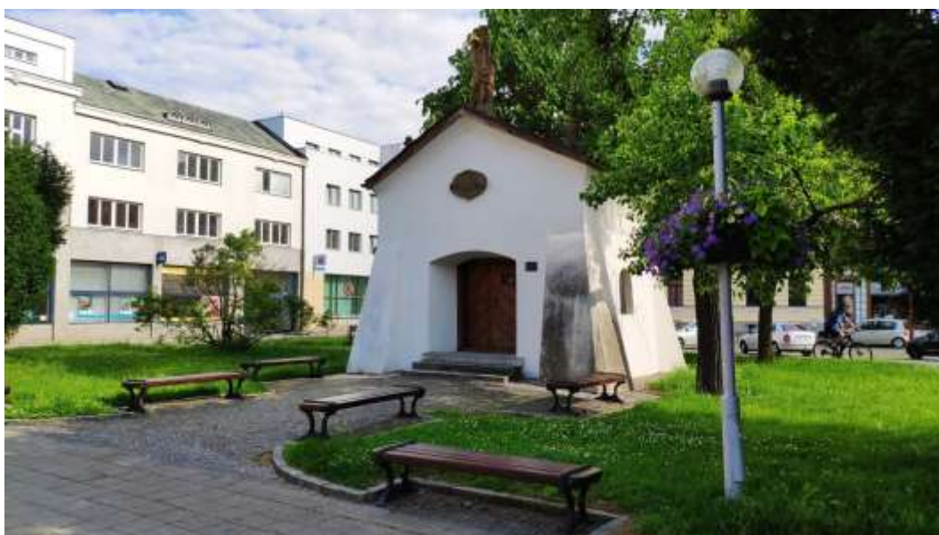
Obr. 85: Veřejné osvětlení na Palackého náměstí. Kulová svítidla, odstupňovaný stožár.
