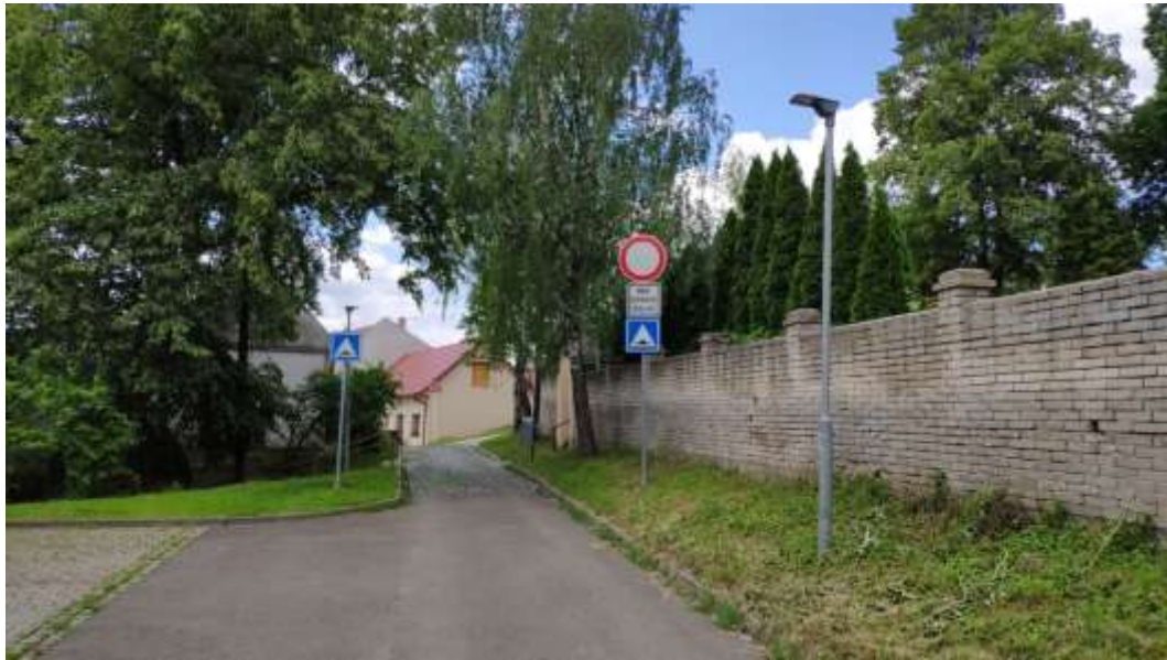
Obr. 122: Charakter VO v ulici Pod Lipkami v okolí kostela Narození Panny Marie – LED svítidla jsou osazená na odstupňovaných stožárech bez patic.
