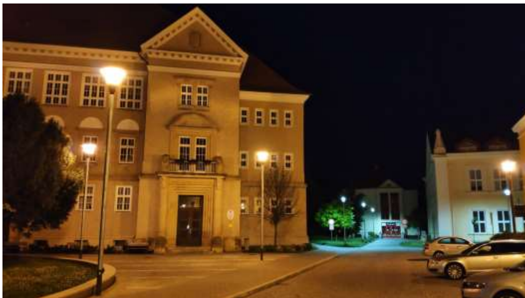
Obr. 80: Charakter VO na Komenského náměstí, noční pohled – příklad neopodstatněné změny teploty chromatičnosti světla.
